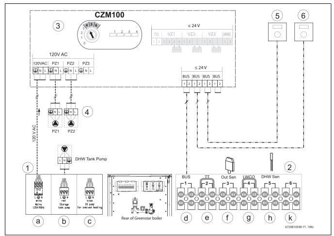
Fig. 15 Wiring
