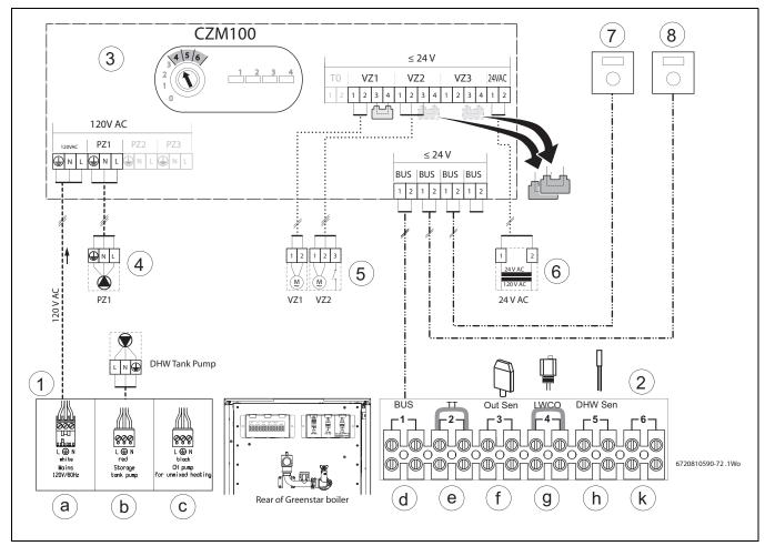
Fig. 12 Wiring
