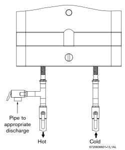
Fig. 7 - Pressure Relief Valve
